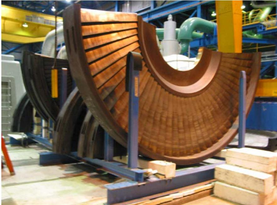
Montage d'un stator de la turbine basse pression
