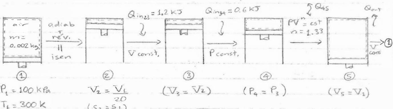
air  $\rightarrow$  gaz parfait avec  $C_p, C_v$  constant :  $C_p = 1.005 \frac{\text{kJ}}{\text{kg} \cdot \text{K}}$
