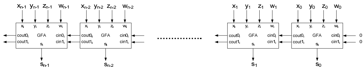
Figure 2 Additionneur itératif à 4 entrées.
