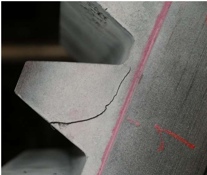
Fissure sur un engrenage*
