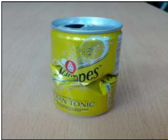
Flambement d'une canette métallique (Source: ETUDE DE LA RESISTANCE AU FLAMBEMENT DE CANETTES METALLIQUES , ENSMP 1ère année, Mécanique des Matériaux Solides)
