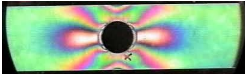
Modèle photoélastique d'une plaque trouée chargée en tension uniaxiale (MEC6405: Analyse expérimentale des contraintes)
