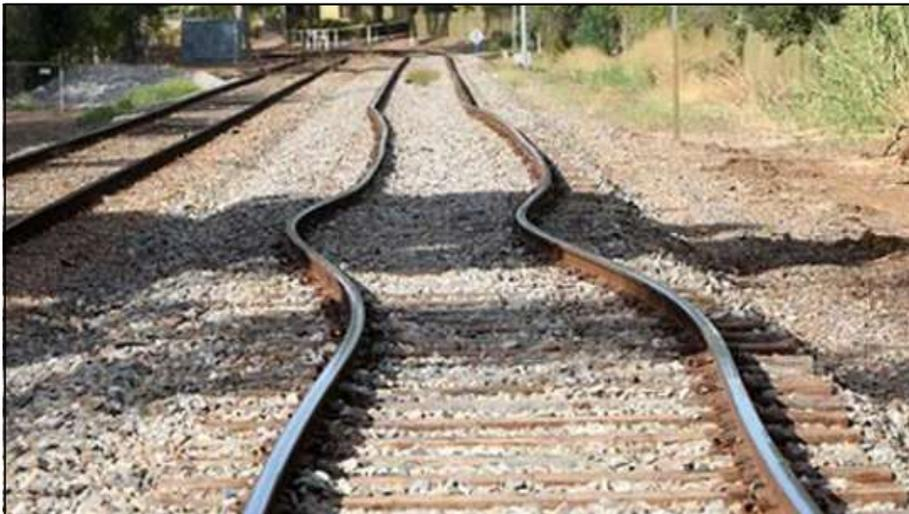
Flambement d'un rail causé par l'élévation de température
