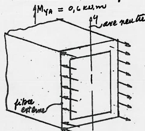
$$(\sigma_x)_{\text{fibre ext.}} = \pm 67,4 \text{ MPa}$$
