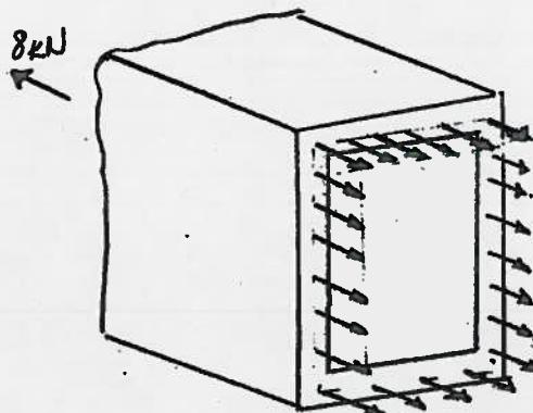
$$\sigma_x = 10,9 \text{ MPa} \\ (\text{uniforme sur la section})$$
