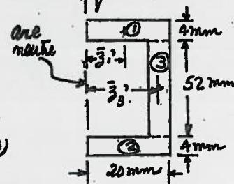
$$\tau_{xz} = \frac{200 \text{ N} \times 5,34 \times 10^3 \text{ mm}^3}{0,178 \times 10^6 \text{ mm}^4 \times 2 \times 4 \text{ mm}} \quad \text{↑ 2 épaisseurs}$$
