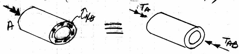
$$\tau_{\text{max}} = \frac{T_{\text{AB}} \cdot r}{J} = \frac{3 \times 10^6 \text{ N} \cdot \text{mm} \times (50 + 2,5/2) \text{ mm}}{2\pi \times (50)^3 \times 2,5 \text{ mm}^4} = 78,3 \text{ MPa} \text{ selon le sens montré}$$
