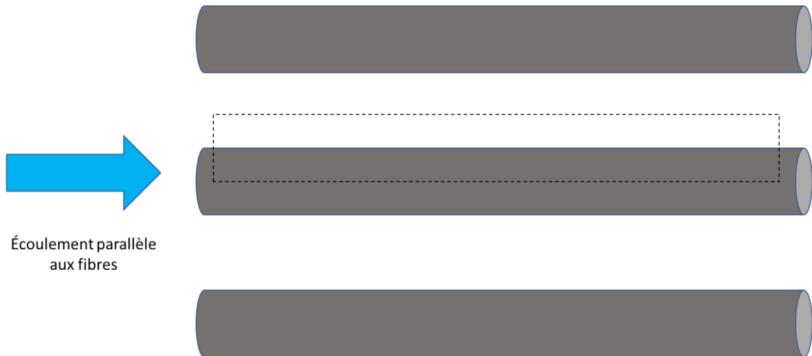
Figure 2 – Schéma d'un écoulement parallèle à un arrangement bidimensionnel régulier et ordonné de cylindres. Le domaine à simuler est en pointillé.
