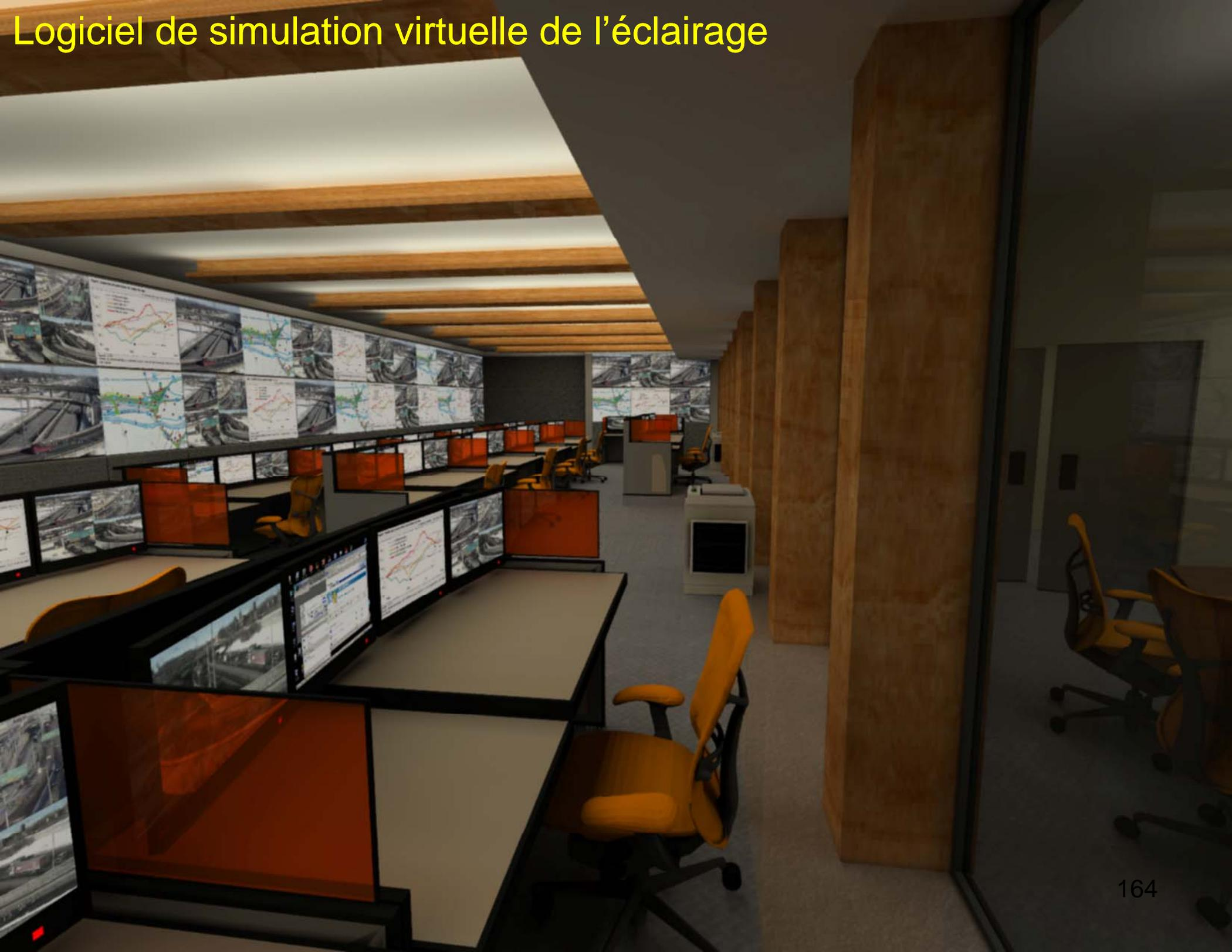
Simulation: Luminaires à 100% et écrans avec luminance de 200 cd/m<sup>2</sup>
