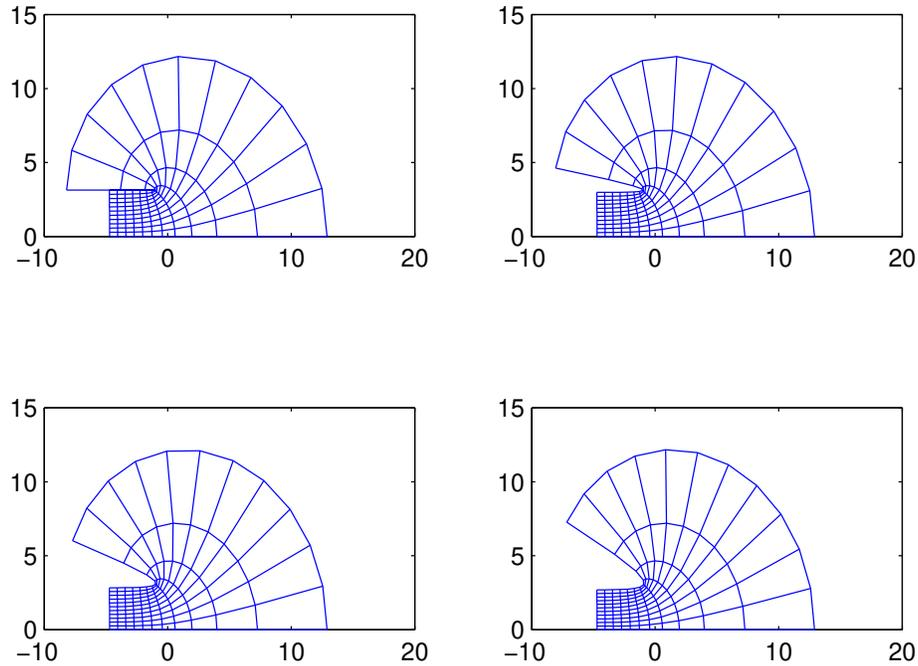
FIGURE 2.2 – Transformation conforme avec la fonction  $z = e^w + w$  avec diverses valeurs du rabattement
