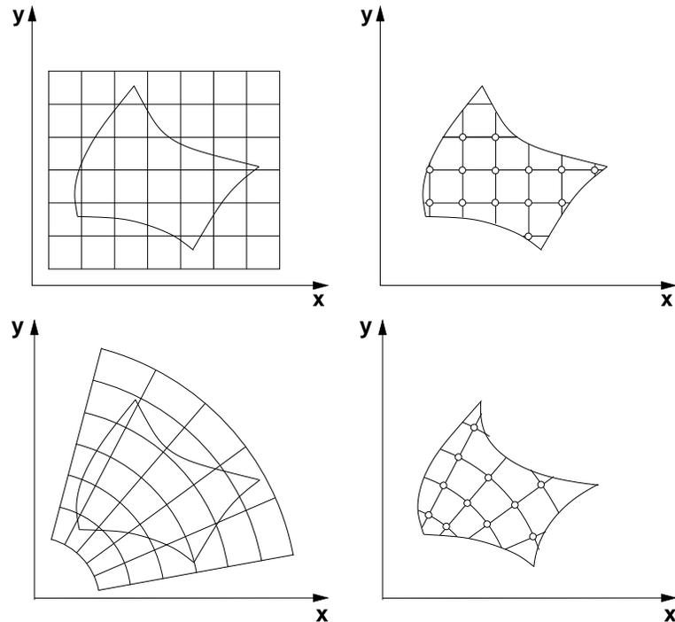
On constate que ces maillages ne sont pas généralement géométriquement conformes car le point de départ n'est pas la géométrie dans l'espace physique mais un maillage régulier dans l'espace paramétrique. Alors, le maillage intérieur doit être raccordé à la discrétisation de la frontière, soit,
