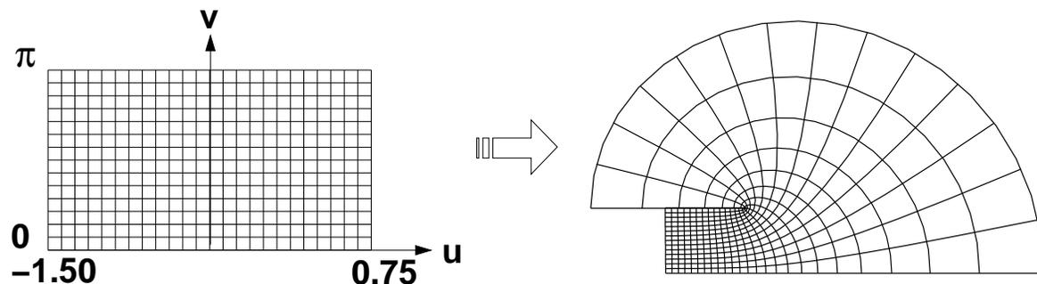
FIGURE 2.1 – Transformation conforme avec la fonction  $z = e^w + w$
