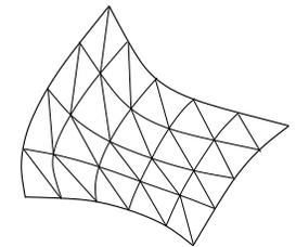
Pour la forme géométrique des éléments en pratique, on retrouve soit des quadrangles (hexahédres) ou des triangles (tétraèdres) curvilignes.
