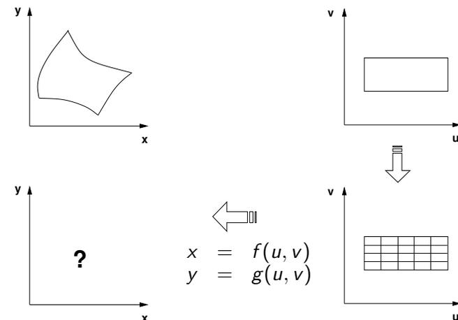
On doit introduire la discrétisation des frontières physiques vers le rectangle paramétrique, et remplacer les transformations algébriques  $f$  et  $g$  par un modèle de maille : interpolant transfini ou système d'équations différentielles.
