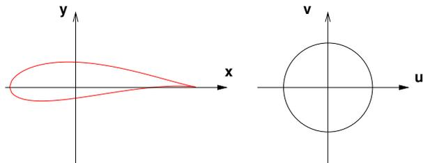
où  $k = \frac{2\pi - \delta}{\pi}$  représente les paramètres du profil et  $\delta$  est l'angle entre deux arcs de cercle au bord de fuite.
