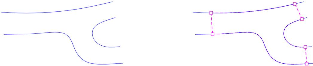
FIGURE 1.15 – Construction d'un domaine quelconque, nonstructuré à partir de la géométrie
