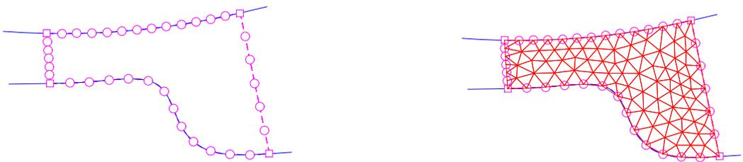
FIGURE 1.16 – Discrétisation des frontières et de l'intérieur pour un maillage non-structuré
