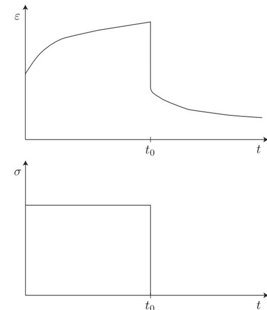
Figure 1: Schématisation d'un essai de fluage – recouvrance 1D
