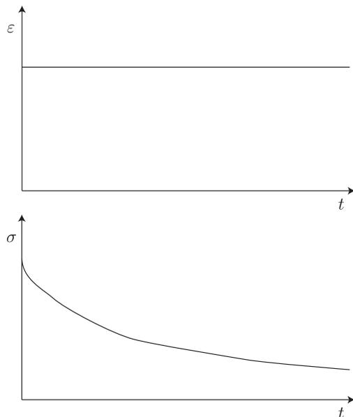
Figure 2: Schématisation d'un essai de relaxation 1D
