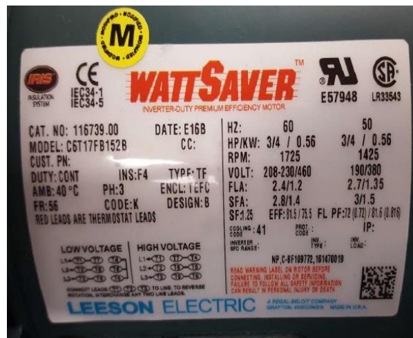
Figure 4. Plaque signalétique du moteur Leeson du laboratoire A-236
