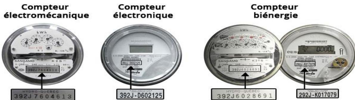
Figure 1. Compteurs de relevés d'énergie (Source)
