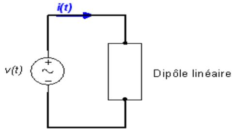
$$\begin{cases} v(t) = V_{\max} \cos(\omega t + \theta_v) \\ i(t) = I_{\max} \cos(\omega t + \theta_i) \end{cases} \Rightarrow \boxed{\varphi = \theta_v - \theta_i}$$
