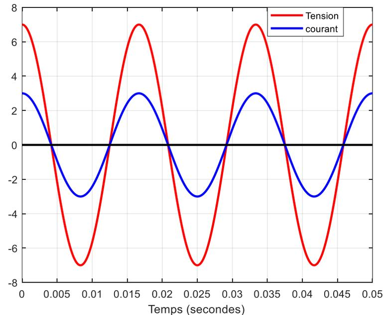
Le courant et la tension sont en phase pour une résistance.
