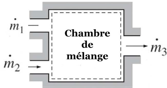
Dispositifs pour mélanger deux écoulements de fluides.
