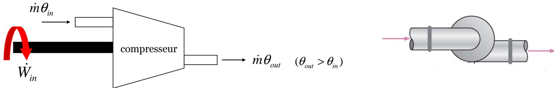
**Un compresseur** absorbe du travail pour augmenter de l'énergie du fluide
