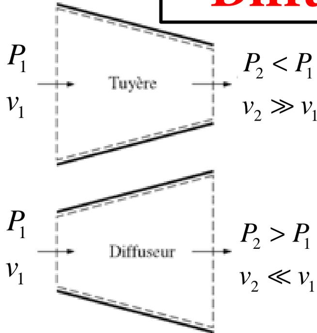
**Une tuyère** est conçue pour accroître la vitesse de l'écoulement
