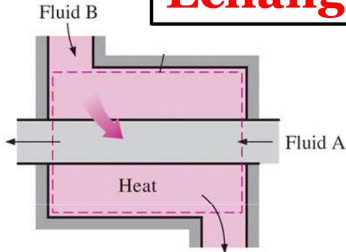
Dispositifs où deux écoulements de fluide s'échangent de la chaleur sans se mélanger.
