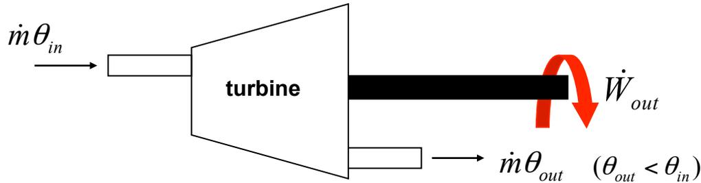
Analyse thermodynamique: En entrée on a typiquement un fluide à haute pression (et haute température). Il peut y avoir plusieurs entrées et sorties. Une turbine idéale est adiabatique ( $Q=0$ ).
