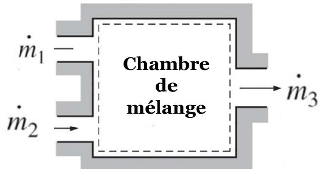
Dispositifs pour mélanger deux écoulements de fluides.
