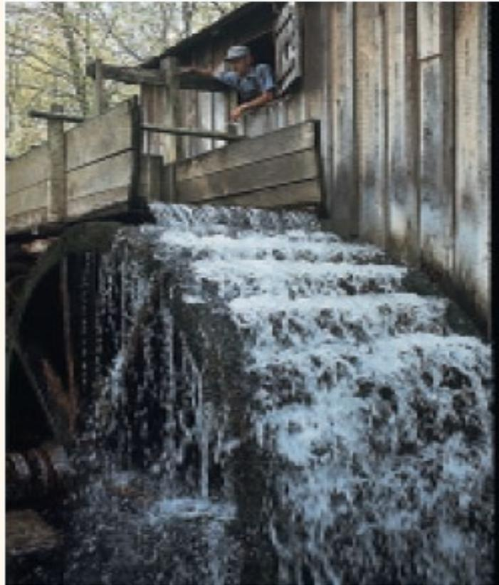
*L'eau qui tombe sur le sommet de la roue à aubes la fait tourner, son énergie potentielle se transforme en énergie mécanique.*
