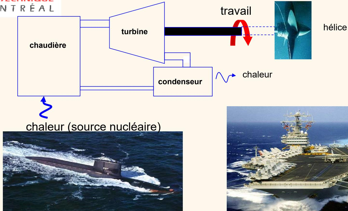
*Les bâtiments à propulsion nucléaire utilisent un ou plusieurs réacteurs nucléaires. La chaleur produite est transmise à un fluide caloporteur utilisé pour générer de la vapeur d'eau actionnant :
