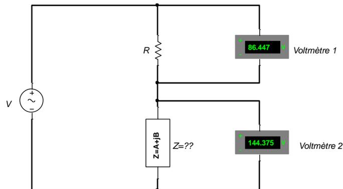
La loi d'Ohm aux bornes de la résistance permet d'obtenir :
