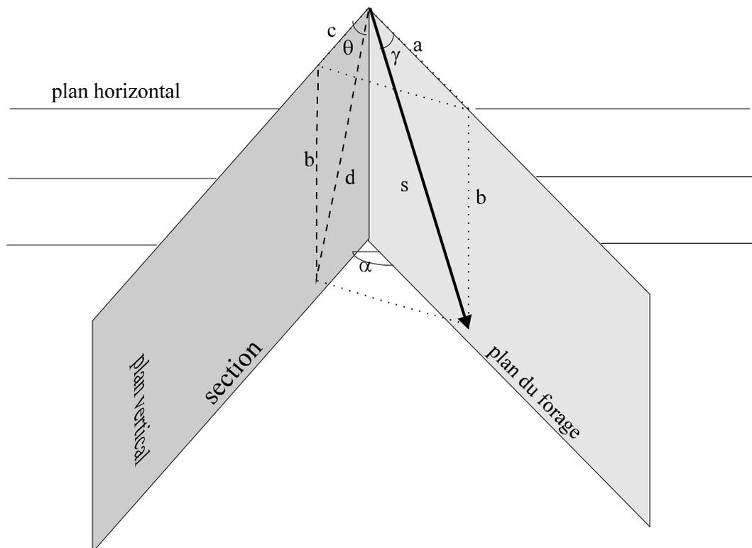
Soit  $\alpha$ : angle entre la direction du forage et le plan de la section verticale.
