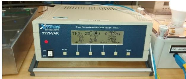
Figure 17. Lecture des harmoniques avec l'analyseur de puissance.
