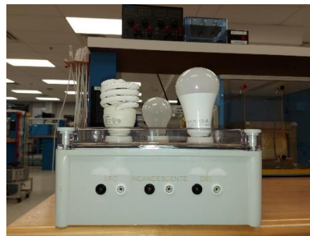
Figure 10. Support et bornes de raccordements des appareils d'éclairage.
