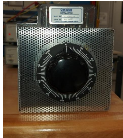
Figure 13. Autotransformateur triphasé max 240 V entre A et B et 120 V entre A et GND
