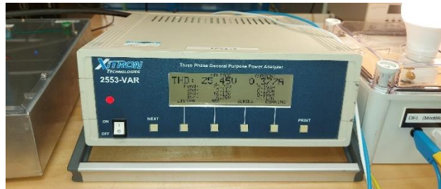
Figure 17. Lecture des harmoniques avec l'analyseur de puissance.
