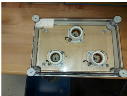
Figure 10. Support et bornes de raccordements des appareils d'éclairage.
