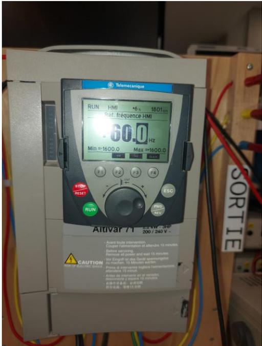
Variateur de vitesse à commande vectorielle: permet de régler précisément la vitesse de rotation.
