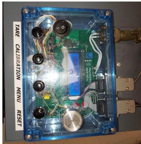
**Figure 6.** Module d'acquisition des données du freinage du moteur
