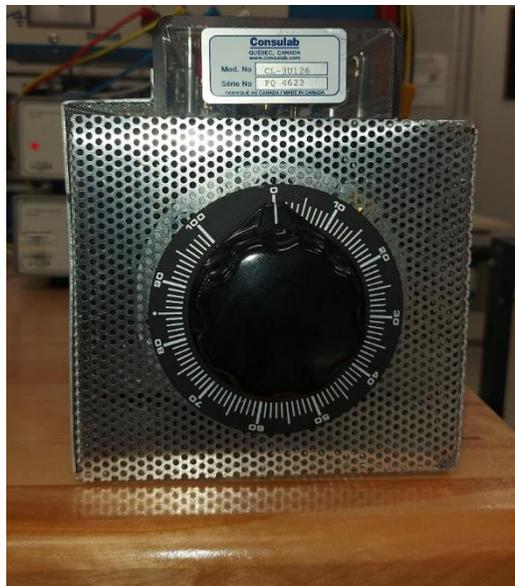
**Figure 10.** Bouton Vernier pour ajuster la tension de sortie de l'autotransformateur triphasé.
