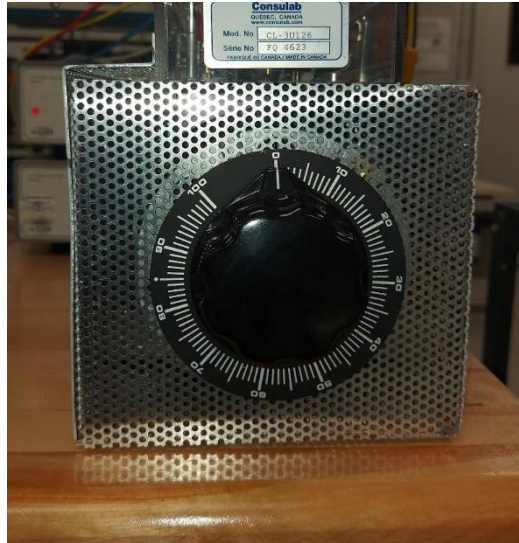
Figure 10. Bouton Vernier pour ajuster la tension de sortie de l'autotransformateur triphasé.
