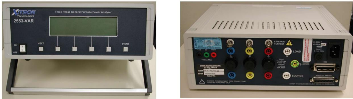
Figure 4. Analyseur de puissance XiTron technologies 2553 (faces avant et arrière)
