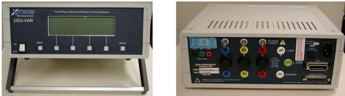
**Figure 4.** Analyseur de puissance XiTron technologies 2553 (faces avant et arrière)
