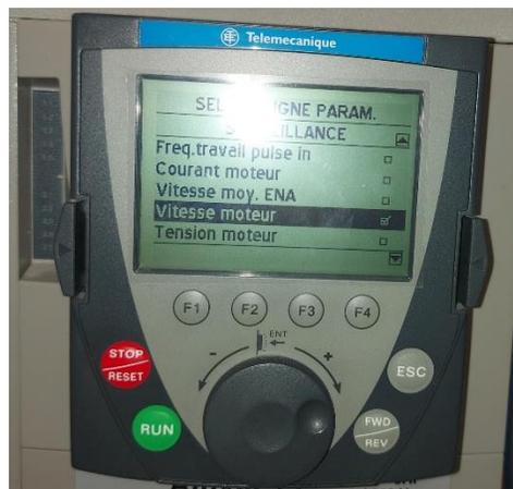
Figure 19. Étapes de configuration du variateur de vitesse pour la lecture des caractéristiques mécaniques.
