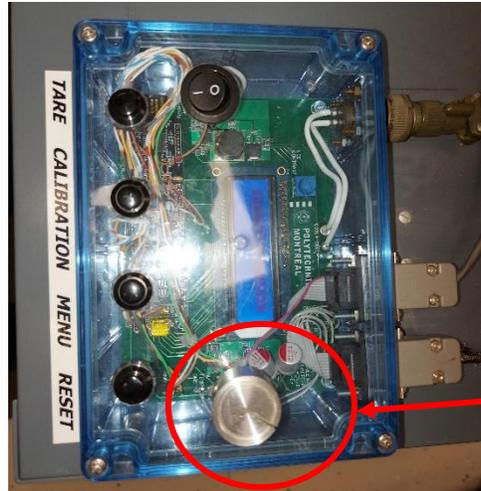
*Bouton Vernier pour ajustement de la charge mécanique.*
