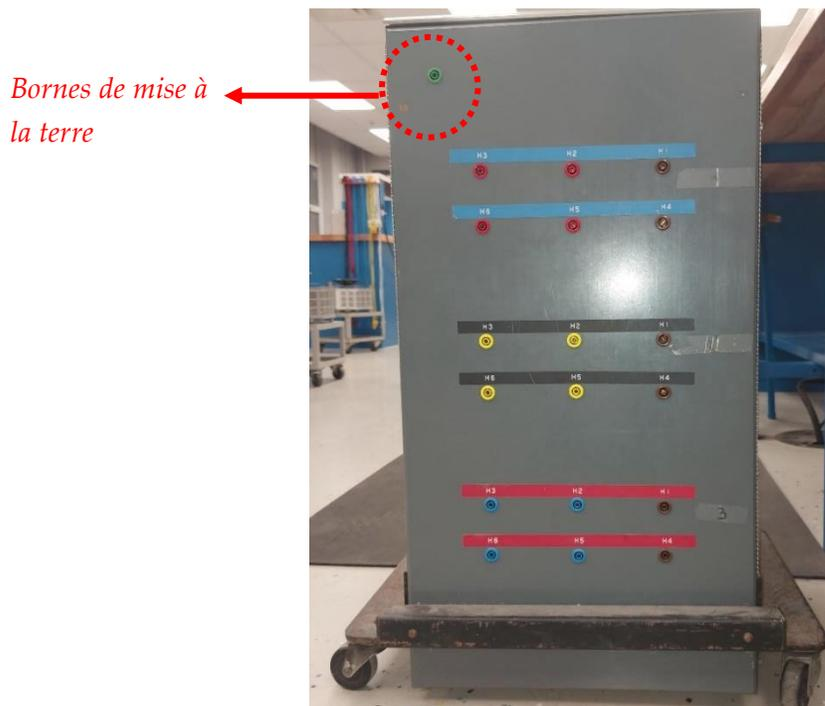
**Figure 11.** Bornes du primaire (bornes H) du transformateur T7-6 d'HAMMOND
