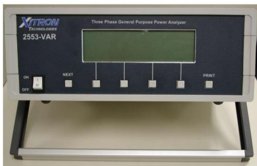
Figure 6. Analyseur de puissance XiTron technologies 2553 (faces avant et arrière)
