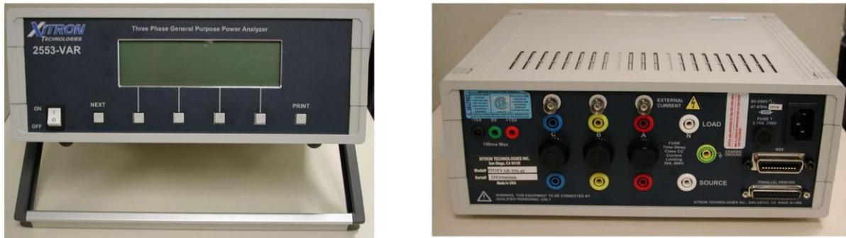
Figure 6. Analyseur de puissance XiTron technologies 2553 (faces avant et arrière)
