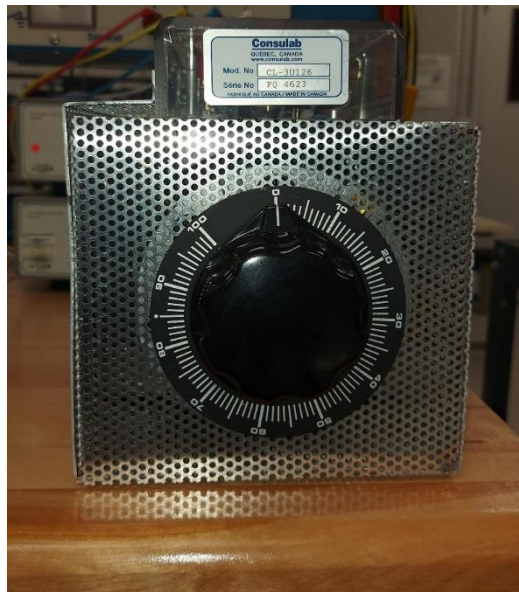
Figure 9. Bouton Vernier pour ajuster la tension de sortie de l'autotransformateur triphasé.
