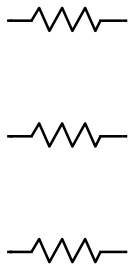
Charge triphasée résistive
