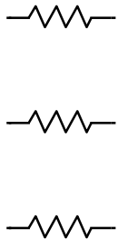
Charge triphasée résistive
