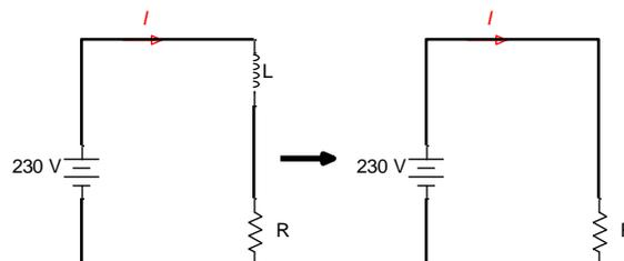
Le courant est alors limité seulement par la résistance et par la loi d'Ohm on obtient :
