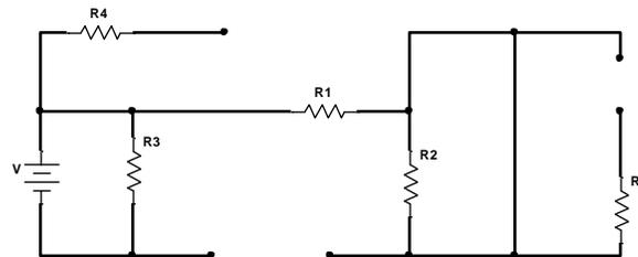
Ce montage **n'est pas correct**, car la règle a été inversée. Les condensateurs sont remplacés par des courts-circuits et des inductances par des circuits ouverts.
