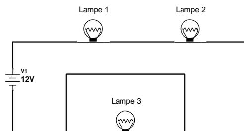
Comme précédemment, en court-circuitant la lampe 3, on offre un autre chemin possible au courant autre que la lampe 3. Si on a donc toujours pas de courant dans le circuit alors, la lampe défectueuse est dans cette situation, soit la lampe 1 ou la lampe 2.
