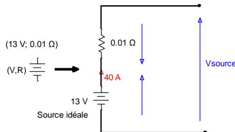
Lorsque la source débite un courant, on aura une chute de tension à cause de sa résistance interne. Cette chute de tension vaut :
