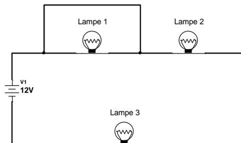
Si les lampes 2 et 3 ne fonctionnent toujours pas alors cela signifie que le circuit reste ouvert, ainsi la lampe défectueuse est soit la lampe 2 ou la lampe 3.
