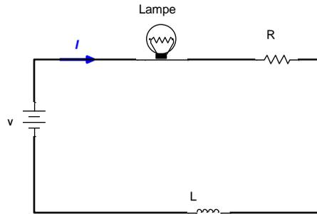
Le sens du courant dépend de celui de la source, ainsi, il ne changera que si on **permuté les bornes de la source V**.
