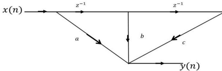
La séquence  $x(n)$  est obtenue par l'échantillonnage d'un signal  $x_a(t)$  à un taux de 1000 échantillons/seconde le signal  $y_a(t)$  est ensuite produit par une conversion numérique/analogique de la séquence  $y(n)$
