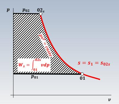
La figure dans le plan p-v (s=cnste.) illustre une compression, isentropique ( $pv^{\gamma}=cnste$ ), entre les points 01-02s.
