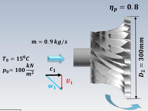
a) le travail spécifique  $W_{\rm e}$ , b) température totale à la sortie  $T_{\rm 02}$ , c) le rapport de pression d'arrêt dans le rotor
