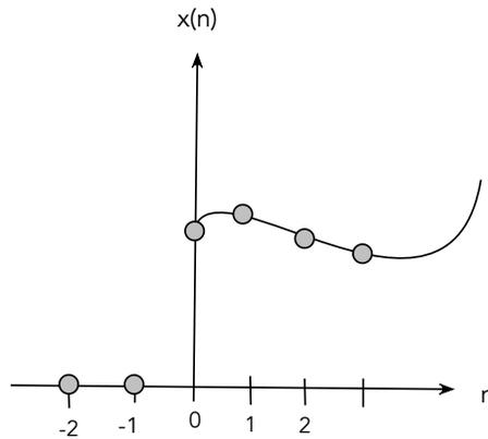
**Définition 11.8.** Un SLS est appelé **causal** si la sortie  $y(n)$  ne dépend que des  $x(k)$  avec  $k \leq n$  (i.e. :  $n - k \geq 0$ ). Ainsi, la réponse du système ne dépend pas du futur de l'entrée.
