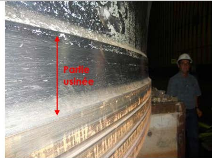
Ceinture de roue usinée pour corriger le balourd mécanique
