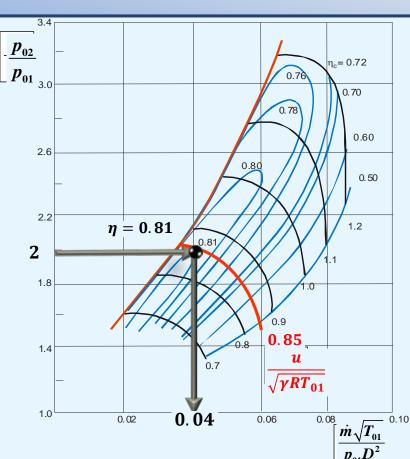
Un compresseur opère au **point nominal**. Le rotor a un diamètre de D = 40cm et le rapport de pression totale est  $p_{02}/p_{01} = 2$ . Les conditions d'entrée sont  $T_{01} = 20^{0}C$ ,  $p_{01} = 1bar$ . Utilisez la carte et déterminez:
