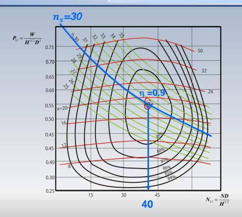
**Remarque**:  $n_s$  a été calculée avec la puissance en CV, la vitesse en rpm et la hauteur en mètres
