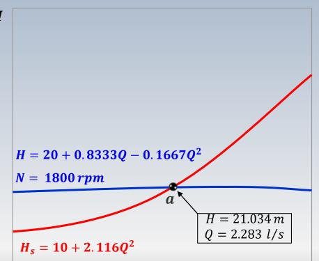
A  $N = 1800 \, rpm$ , le point d'opération identifié avec l'indice a, correspond à l'intersection de la courbe caractéristique de la pompe H avec celle de la conduite  $H_s$ Pour trouver les conditions au point b, à  $N = 3600 \, rpm$ , nous utiliserons la similitude des coefficients de débit  $\Phi$ , et de charge **Ψ**
