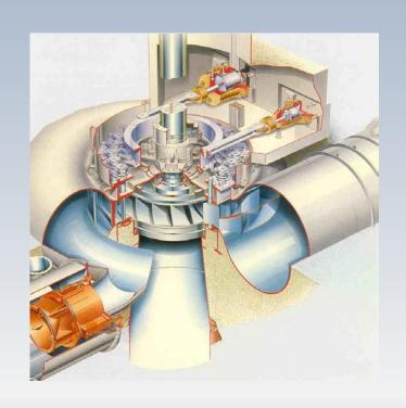
Une turbine Francis (simple), opère avec une charge H=60m et un débit  $Q=30\,m^3/s$ . Le rendement est  $\eta=88\%$ . Utilisez la carte et estimez les rpm et le diamètre D de la roue.
