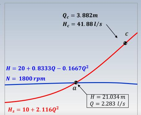
Le point  $(Q_{a}, H_{a})$  ne peut pas être utilisée directement pour trouver la vitesse de rotation demandée, car aucune loi de similitude n'a été considérée entre les points a et c
