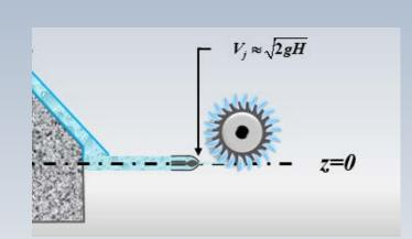
Le débit apparait implicitement dans l'équation pour la puissance, qui correspond à l'énergie potentielle par unité de temps fois le rendement
