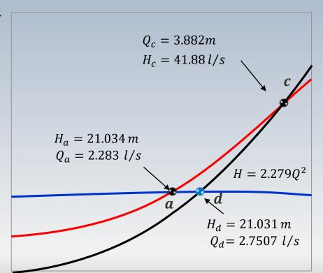
L'intersection de la parabole  $H=2.279Q^2$  avec la courbe caractéristique de la pompe  $H=20+0.8333Q-0.1667Q^2$  mène au point  $(\mathbf{Q_{d}},\mathbf{H_{d}})$
