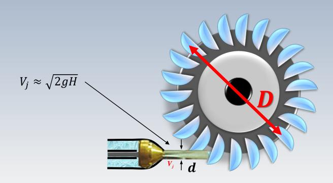
Un seul injecteur et sur la base du point de design (le point nominal), déterminez: la vitesse de rotation, le diamètre du jet de l'injecteur et le diamètre de la roue.
