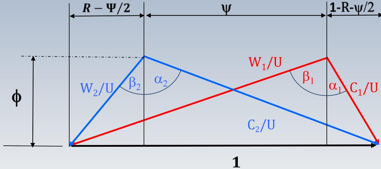
La mise à l'échelle par la vitesse tangentielle  $U$ , permet également l'obtention du triangle normal pour un compresseur
