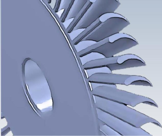
**Rotor à réaction**
