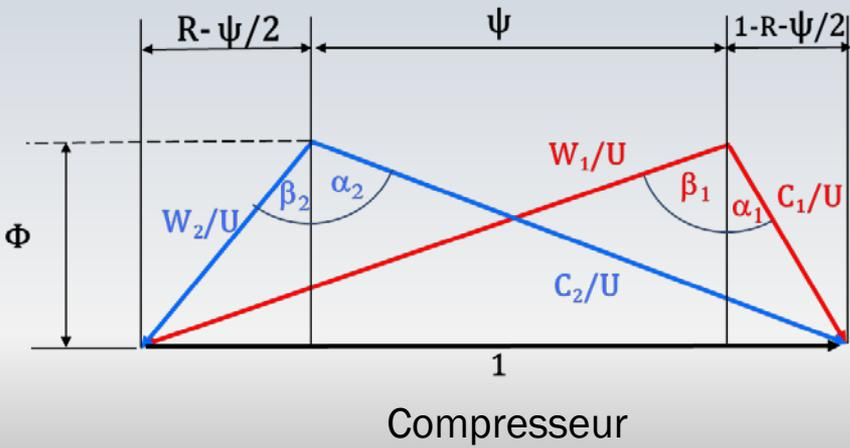
Pour une machine axiale, le triangle adimensionnel de vitesses caractérise les notions de: **travail spécifique** (ou enthalpie), **débit** et **angles d'entrée et de sortie** du rotor
