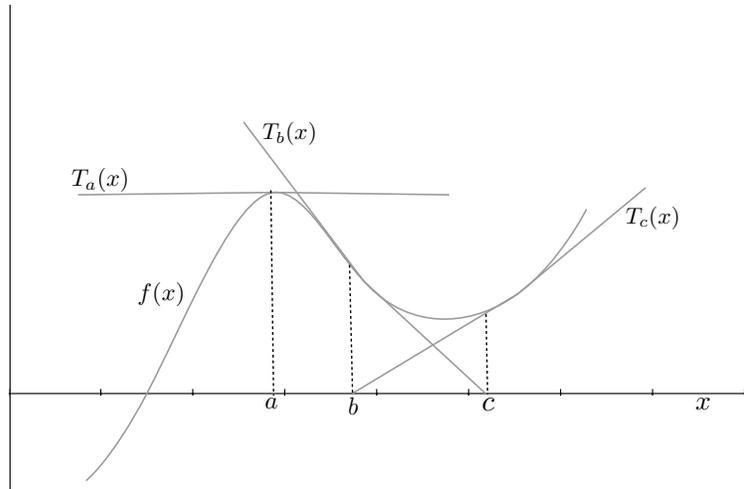
On désire utiliser la méthode de Newton pour calculer une approximation de la racine  $r$  de la fonction  $f(x)$ .
