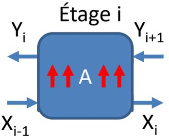
Au fur et à mesure que le solvant progresse d'étage en étage, il retient de plus en plus de matière A, extrayant ainsi A du produit.
