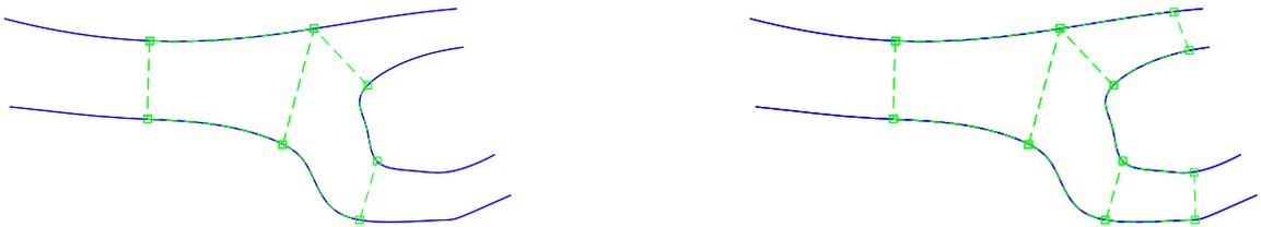
FIGURE 4 – Construction d'un domaine multi-blocs
