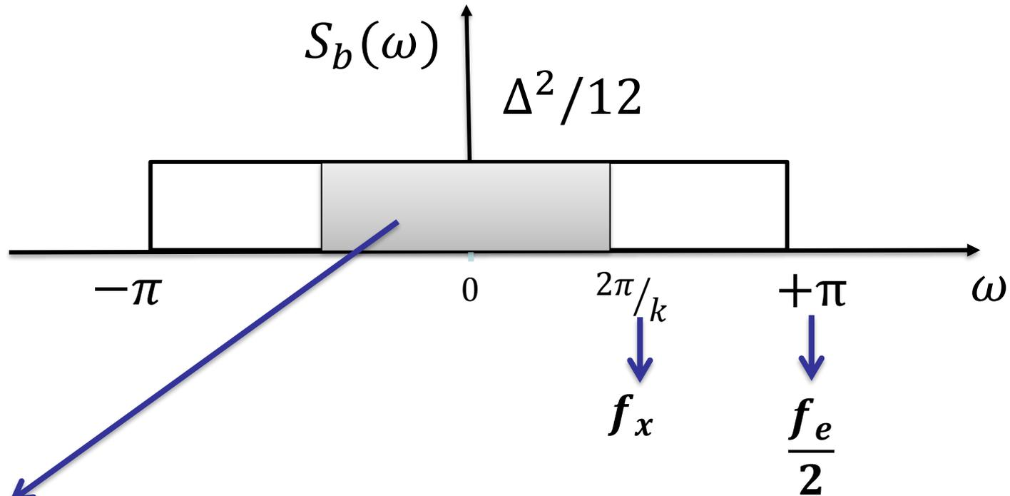
➤ Puissance du bruit de quantification dans la bande de fréquence utile du signal:  $S_b(\omega)$
