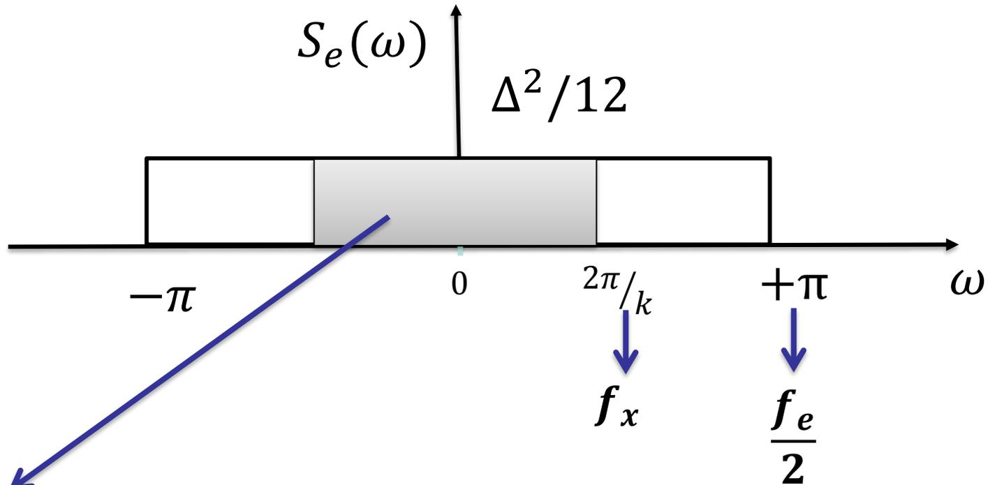
➤ Puissance du bruit de quantification dans la bande de fréquence utile du signal:  $S_e(\omega)$
